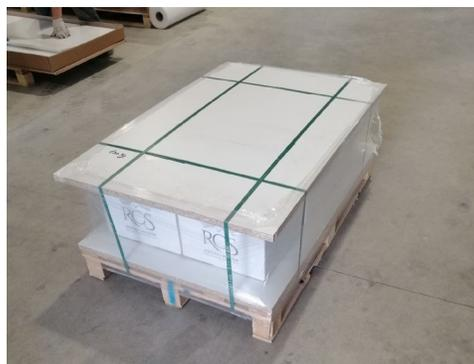
Esempio di imballaggio fatto su pallet con pannello contenitivo a protezione degli urti e sovrapposizione merce. La parte laterale risulta scoperta ma protetta con cartone e film protettivo.
