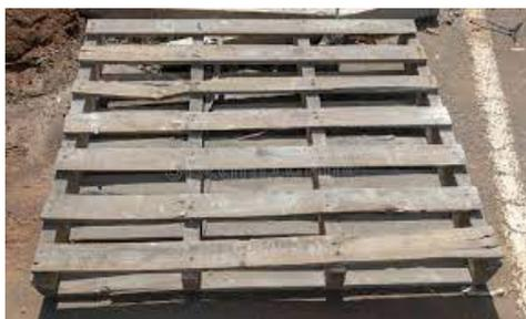
Esempio di pallet non idoneo al trasporto. Si raccomanda di utilizzare materiale integro così da evitare la rottura della merce durante lo scarico della merce.
