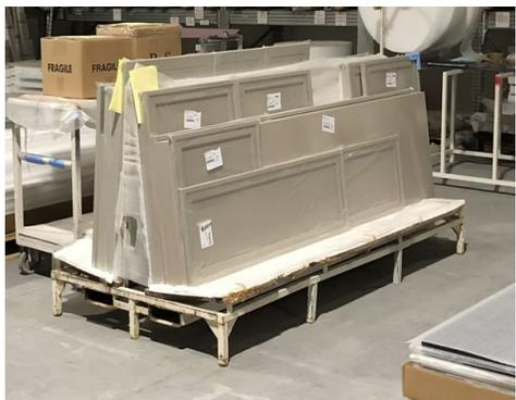
Esempio di imballaggio fatto su gabbia metallica. L'imballaggio risulta idoneo allo scarico del materiale, grazie al sistema di inforcamento su tutti i lati della gabbia. Si raccomanda l'applicazione di FILM PROTETTIVO per garantire l'integrità del prodotto e del trasporto
